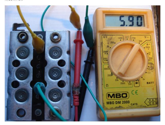
Wenn alles funktioniert wird der Drehstrom in welligen Gleichstrom umgewandelt (siehe Bild). Dies jedoch nur theoretisch. Die Batterie glättet die Welligkeit weitgehend, so das sie mit einem Meßgerät nicht mehr zu messen ist
