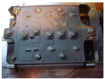
Auf der Unterseite sind die Leiterbahnen, die die Dioden und die Anschlüsse verbinden. Hier kann man prüfen ob eventuell Leiterplatten gesprungen sind. Diese sieht gut aus. Gesprungene leiterplatten kann man nachlöten. Dazu muss aber erst die graue Isolierung entfernt werden.
